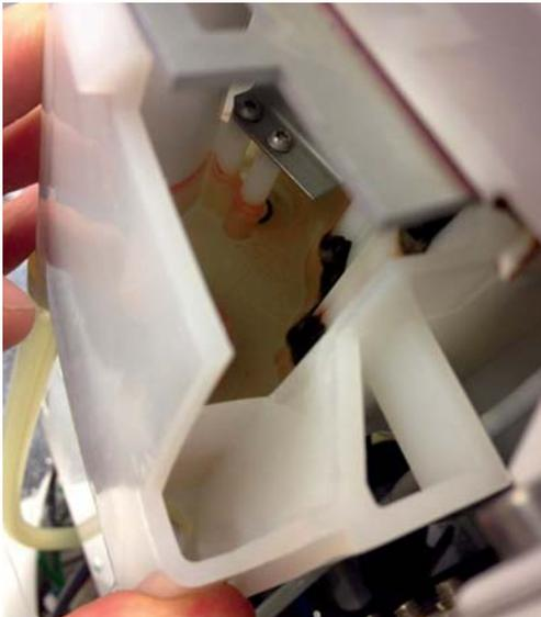
Abb. 1: Freie Fallstrecke gemäß DIN EN 1717 in Dentaleinheit.
