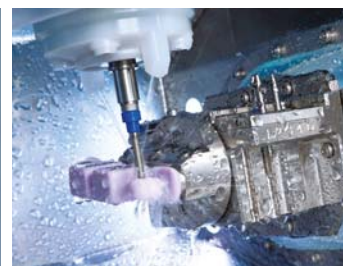
Die neue DWX-4W Nassschleifeinheit
