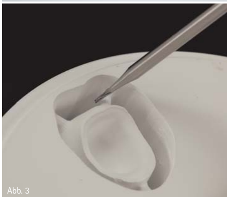
Abb. 1: Konstruktion der vollanatomischen Krone. – Abb. 2: Die Krone wurde aus einer KATANA STML-Disc herausgeschliffen. – Abb. 3: Herausstrennen der Krone aus der Disc mit einem Fissurenbohrer (H349). – Abb. 4: Die gefräzte Krone im Weißlingszustand.
