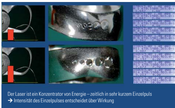
Abb. 31: Drittes Experiment: Laserstrahlung auf Metallband mit Einzelpulsen.
