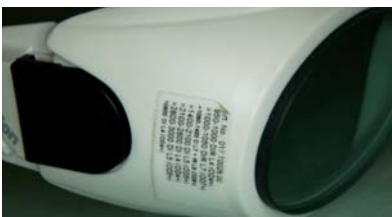
Abb. 27: Kennzeichnung der Schutzbrille: Schutzstufe, Wellenlänge, Betriebsart.
