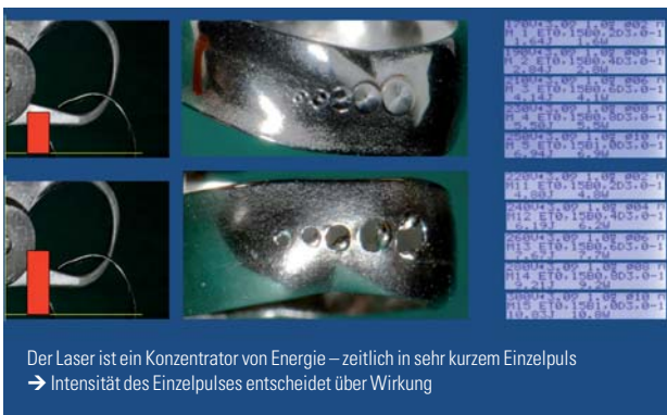
Abb. 31: Drittes Experiment: Laserstrahlung auf Metallband mit Einzelpulsen.
