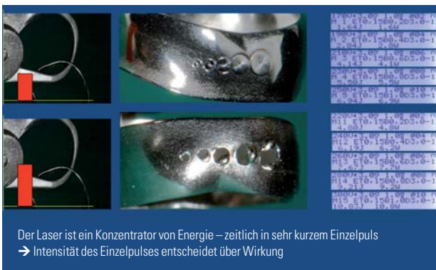
Abb. 31: Drittes Experiment: Laserstrahlung auf Metallband mit Einzelpulsen.
