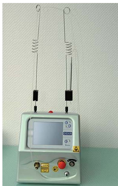
Abb. 7: Diodenlasergepumpter 2\omega Nd:YAG-Laser als Tischgerät.
