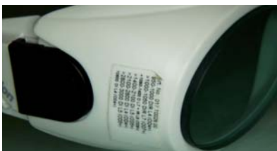
Abb. 27: Kennzeichnung der Schutzbrille: Schutzstufe, Wellenlänge, Betriebsart.
