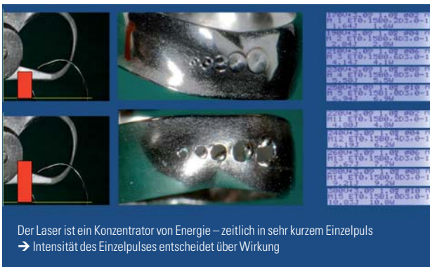
Abb. 31: Drittes Experiment: Laserstrahlung auf Metallband mit Einzelpulsen.
