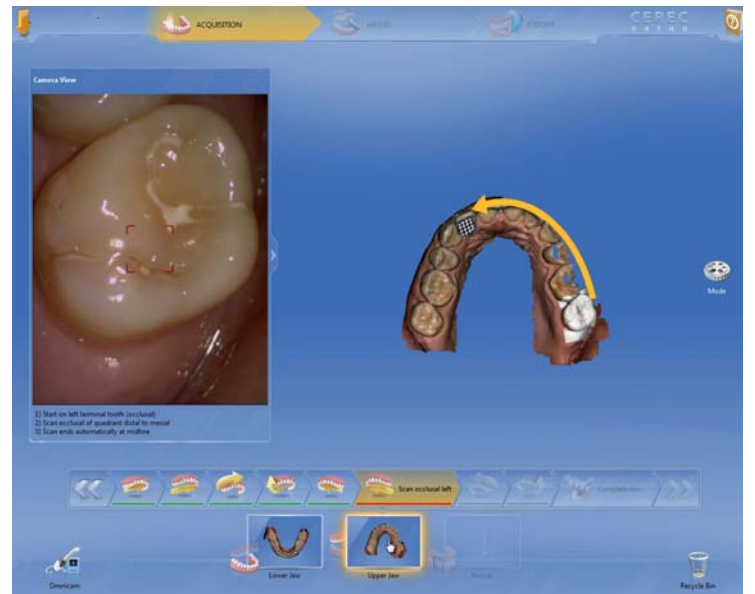
CEREC Ortho Software: Mit einem geführten Scan werden die Kiefer digital abgeformt. Die daraus entstehenden Daten können über die Software digital versendet werden.
