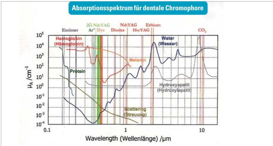
Abb. 22: Laser-Gewebe-Wechselwirkung in Abhängigkeit von der Laserwellenlänge.
