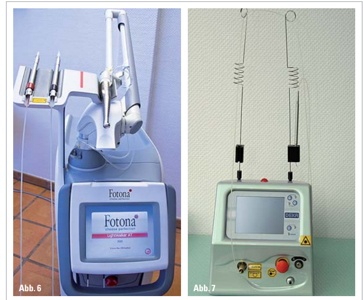
Abb. 6: Multiwave-Gerät, bestehend aus gepulstem Nd:YAG- und Er:YAG-Laser. – Abb. 7: Diodenlasergepumpter 2ωNd:YAG-Laser als Tischgerät.
