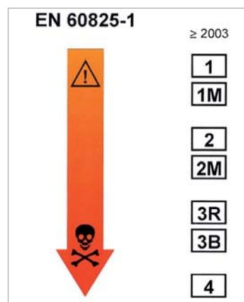
Abb. 26: Die DIN-Norm EN 60825-1 unterscheidet verschiedene Laserklassen.
