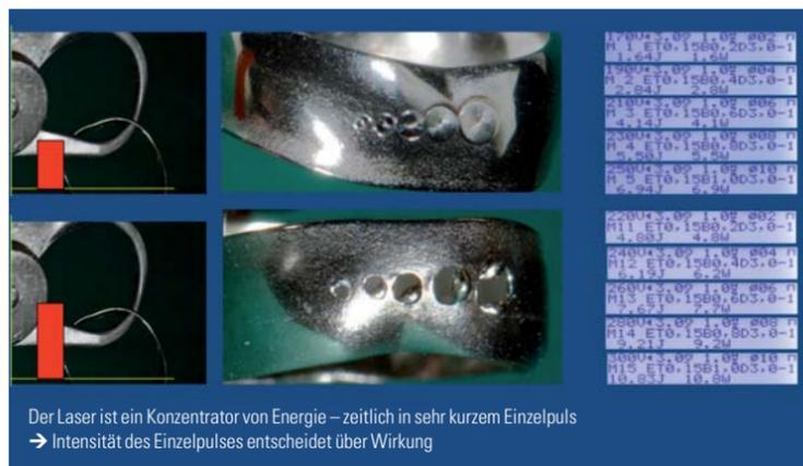
Abb. 31: Drittes Experiment: Laserstrahlung auf Metallband mit Einzelpulsen.
