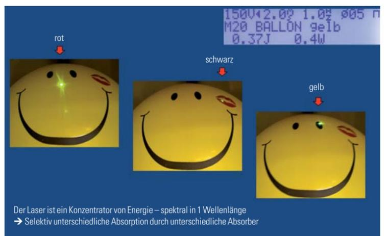
Abb. 30: Zweites Experiment: Laserstrahlung auf drei unterschiedliche Chromophore.
