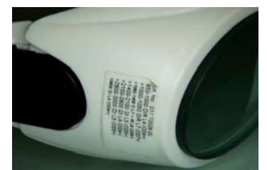
Abb. 27: Kennzeichnung der Schutzbrille: Schutzstufe, Wellenlänge, Betriebsart.
