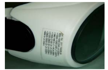
Abb. 27: Kennzeichnung der Schutzbrille: Schutzstufe, Wellenlänge, Betriebsart.
