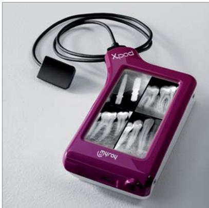
lösenden Touchscreen-Display betrachten Sie die Röntgenbilder ganz ohne Computer, Kabel oder Netzteile. Der Xpod ist mit CMOS Sensoren der neusten Generation ausgestat-
