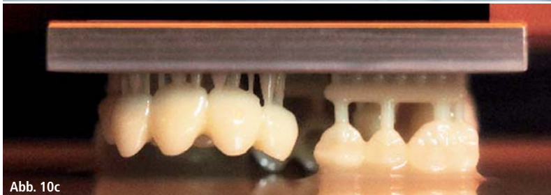
Abb. 10a und b: 3-D-gedrucktes Meistermodell mit Bohrschablone. – Abb. 10c: 3-D-Druck von temporären Versorgungen A2 und A3.
