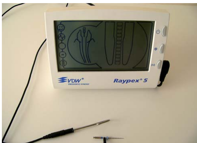
Abb. 4: Messsystem zur Wurzelkanalvermessung mit am Messstift angekoppelter Elektrode, (Bildmitte unten) und Neutralelektrode für die Lippe (über Messstift). Vorliegende Messeinrichtung hat abnehmbare Elektroden.
