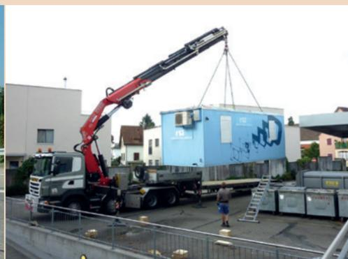
*Schnell aufgeladen: Die mobile Zahnarztpraxis kommt fixfertig per Lastwagen zu Ihnen an den Einsatzort. – Rasch und sicher transportierbar: Die Dentalbox braucht nur eine Fläche von vier Parkplätzen (Grundmasse: 3 x 8 x 3 Meter). – Schnell abgeladen und einsatzbereit: Es erfolgt der Anschluss an Wasser- und Stromanschlüsse. Die Heizung und Kühlung übernimmt eine Split-Klimaanlage.*
