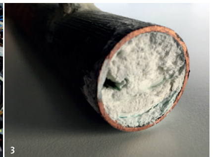
Abb. 1: Biofilm in einer freien Fallstrecke gem. DIN EN 1717 aus Plastik. – Abb. 2: Biofilm im Desinfektionsmittelkonzentratschlauch einer Dentaleinheit. – Abb. 3: Mineralische Ablagerung in der Verteilung einer Trinkwasserinstallation. – Abb. 4: Korrosion einer verzinkten Stahlleitung.
