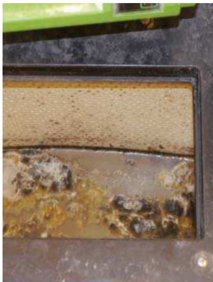
Biofilme in Trinkwasserinstallation und in dentaler Behandlungseinheit
