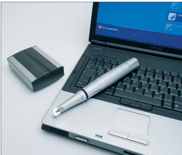
Die kabellose Intraoralkamera VistaCam CL.iX steht für gestochen scharfe Bilder bei hoher Flexibilität und Beweglichkeit. Den Ingenieuren von Dürr Dental gelang es jetzt, die Funkfrequenz der VistaCam CL.iX in den freien Bereich um 5,8 Gigahertz (GHz) zu verlegen.
