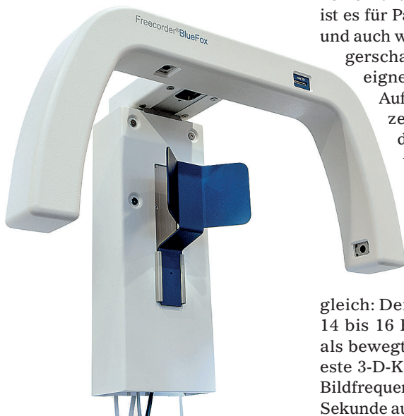
Abb. 1: Freecorder®BlueFox zur Aufzeichnung der individuellen Kieferbewegungen.
