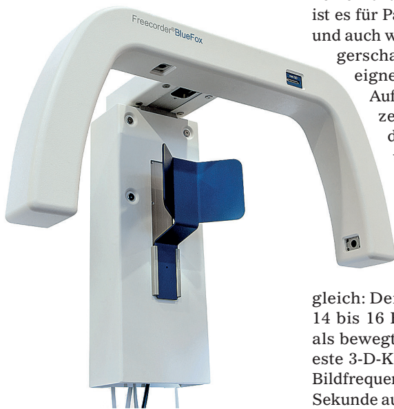
Abb. 1: Freecorder®BlueFox zur Aufzeichnung der individuellen Kieferbewegungen.
