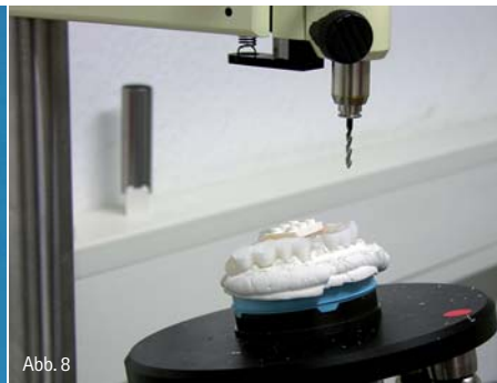
Abb. 7: CT-Schablone für das Implant3D-Verfahren. – Abb. 8: Hexapod zum Umbau der CT-Schablone in eine Operationsschablone. – Abb. 9: In die zahn- und schleimhautgelagerte Operationsschablone überführte CT-Schablone.
