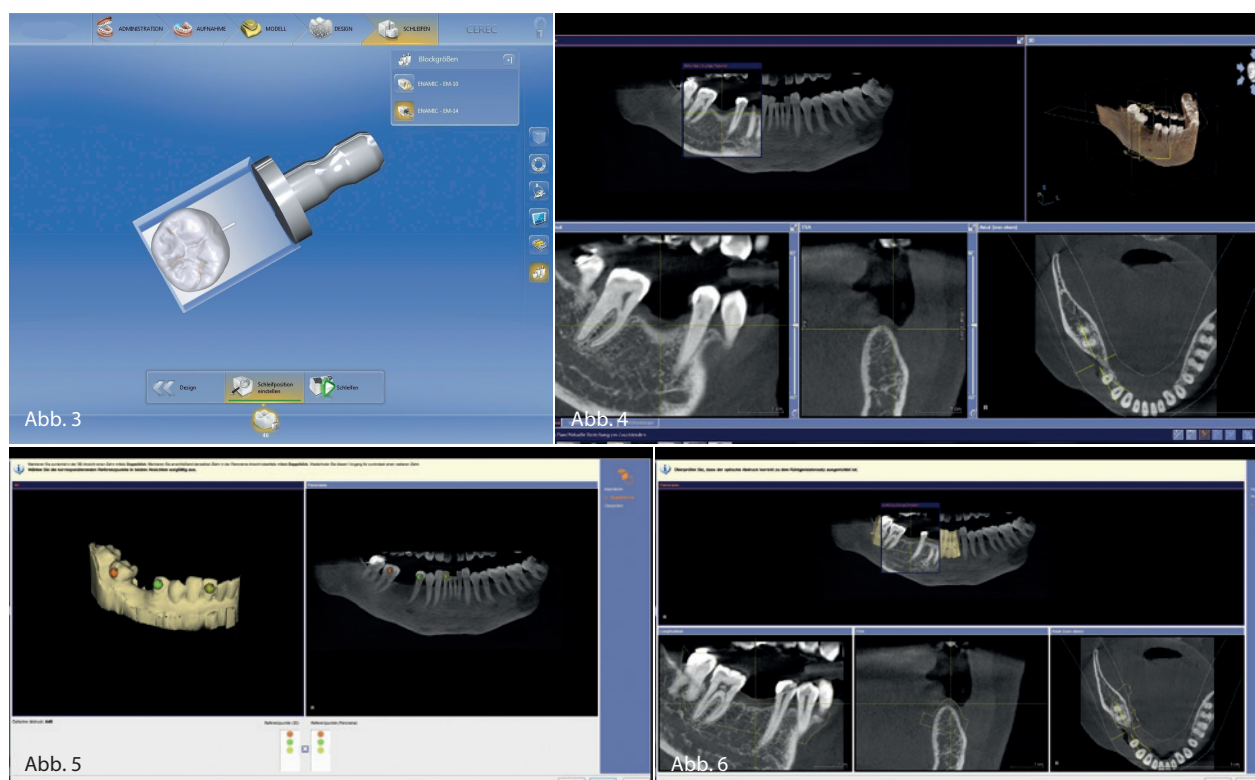
Abb. 3: Die Krone in der Schleifvorschau, Export in das SSI-Format möglich. Abb. 4: Das DVT, eine Grundlage der Implantatplanung. Abb. 5: Der Dialog zum Anbringen der Referenzmarken zum eindeutigen Matching. Abb. 6: Eine nochmalige Kontrollansicht, die den Umriss des CEREC-Modells auf das DVT projiziert.
