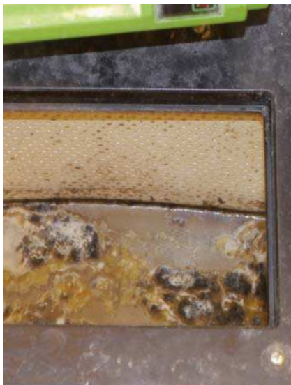
Biofilme in Trinkwasserinstallation und in dentaler Behandlungseinheit
