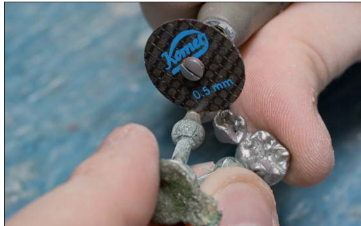
Abb. 19: Nach dem Abstrahlen wird die Brücke mit einer Gewebe verstärkten Trennscheibe von den Gusskanälen getrennt.
