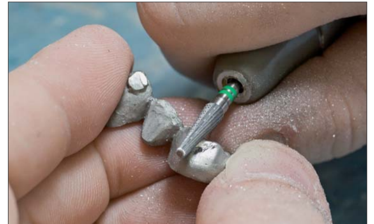
Abb. 20: Ein aggressiver Fräser mit hoher Initialschärfe, wie NE-Fräser von KOMET/GEBR. BRASSELER, tragen selbst hartes Material zügig ab.
