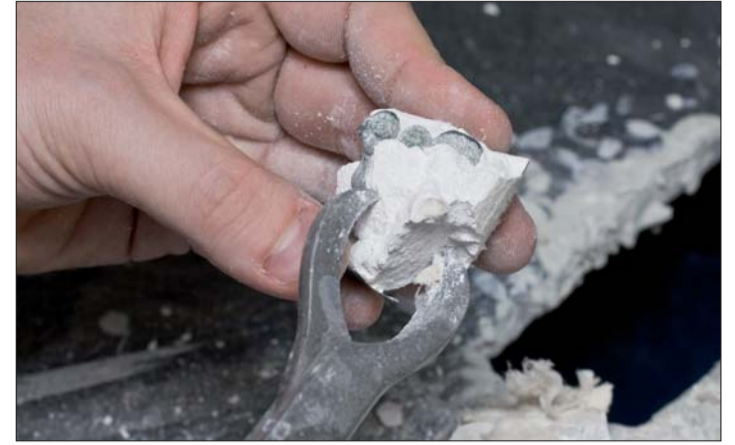
Abb. 16: Mit einer Zange wird die Einbettmasse vom Gussobjekt entfernt.
