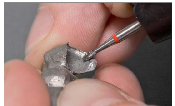
Abb. 23: Überstehende Föhnchen werden mit einem Hartmetall-Ei entfernt.
