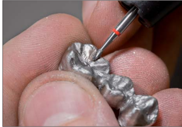
Abb. 29: Eiförmige Fräser eignen sich gut für die Kaufläche ...
