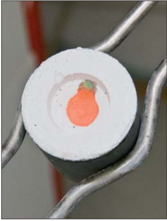
Abb. 13: Nach dem Gießen wird die Muffel zum Abkühlen an einen zugfreien Ort gestellt.
