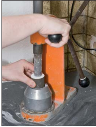
Abb. 14: Wenn die Muffel handwarm ist, kann sie mit Handdruck ausgebettet ...
