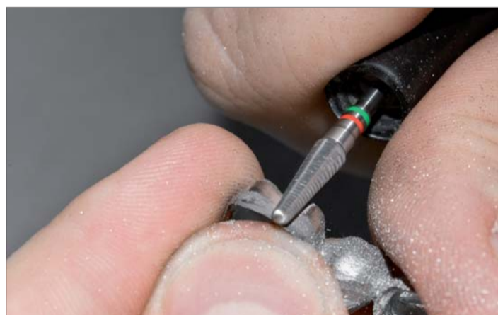
Abb. 22: Der grün-rot gekennzeichnete NE-Fräser hat eine speziell konstruierte Schneide, die sehr weich und vibrationsarm rotiert und glatte, leicht polierbare Oberflächen hinterlässt.
