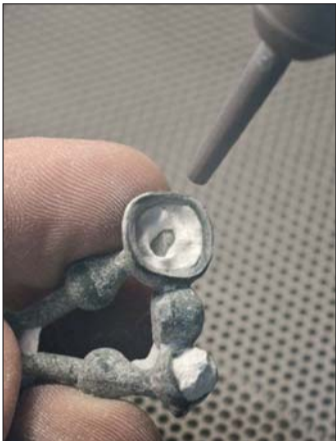
Abb. 17: Mit Aluminiumoxid wird das Gussobjekt von der Einbettmasse und der Oxidschicht befreit.
