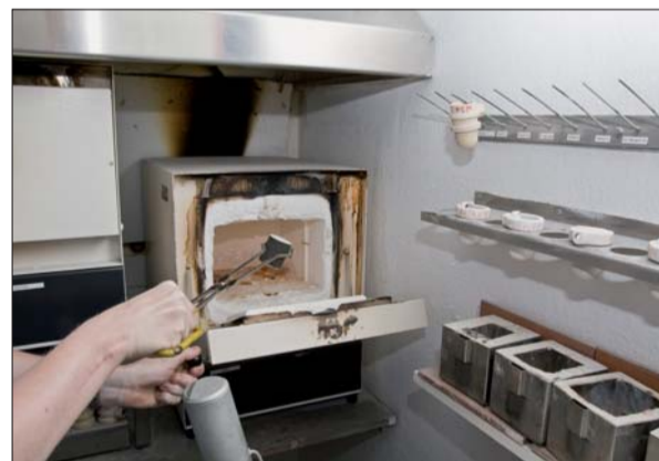
Abb. 9: Wenn die Einbettmasse abgebunden ist, kann die Muffel entformt und mit dem Gussstrichter nach unten in den Vorwärmofen gestellt werden.
