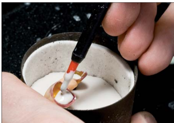
Abb. 8: Mit einem dünnen Pinsel wird die Einbettmasse vorsichtig in die Käppchen gefüllt.
