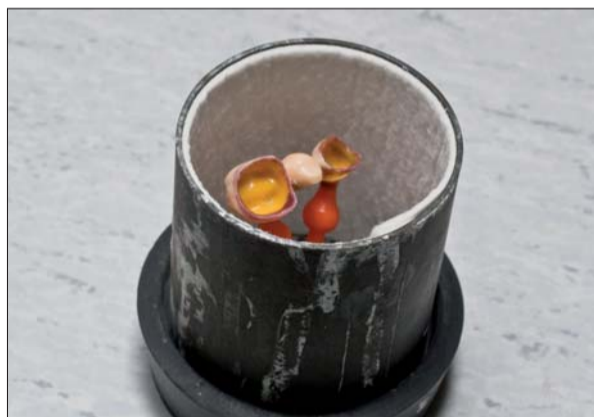
Abb. 7: Der Muffelring wird mit Muffelvlies ausgekleidet, das die Expansion der Einbettmasse auffängt.
