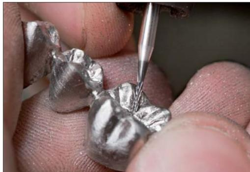
Abb. 30: ... und in die Fissuren gelangt man mit einem schlanken konischen Fräser.
