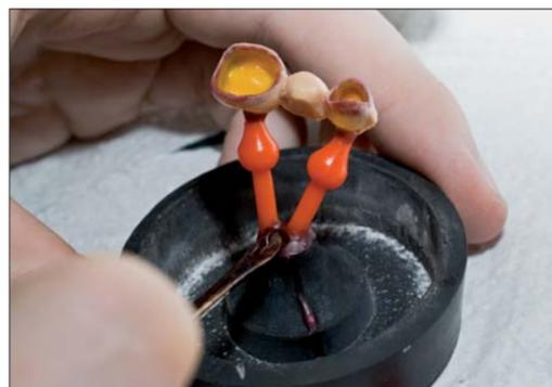
Abb. 6: Die abgehobene Wachsbrücke wird auf einem Sockelträger mit Trichterform festgewachsen.
