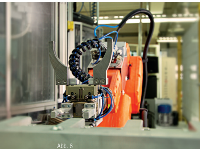
Abb. 6 und 7: Das Technologiezentrum verfügt über zwei Robotersysteme zur Bestückung der Fertigungseinheiten mit Rohlingen.
