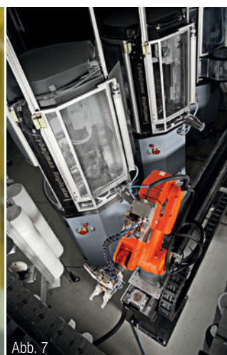
Abb. 6 und 7: Das Technologiezentrum verfügt über zwei Robotersysteme zur Bestückung der Fertigungseinheiten mit Rohlingen.
