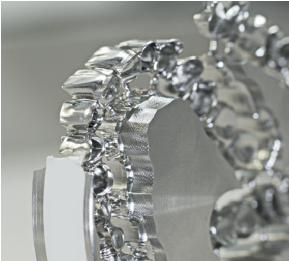
Abb. 11: Gefräste Versorgung aus einer CoCr-Legierung im Rohling.
