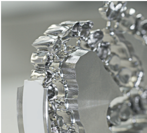
Abb. 11: Gefräste Versorgung aus einer CoCr-Legierung im Rohling.
