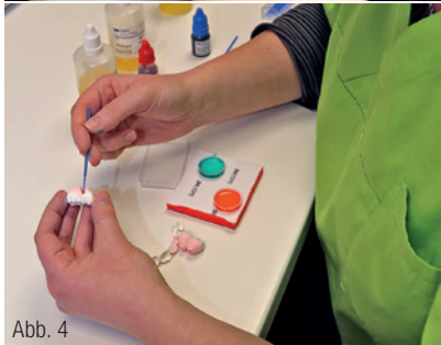
Abb. 1: Computergestützte Konstruktion mit der inLab-Software bei Miadent. Abb. 2: Bestückung der Maschine inLab MC X5 mit einem Lava Plus Zirkonoxid-Rohling. Abb. 3: Das Team des zahntechnischen Labors Miadent. Abb. 4: Individuelles Einfärben der gefrästen monolithischen Versorgung ... Abb. 5: ... mit Lava Plus Färbelösungen. Abb. 6: Applikation von Malfarben und Glasur nach dem Sintervorgang.
