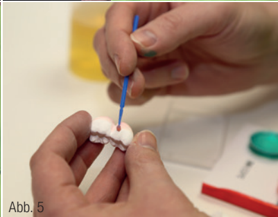
Abb. 1: Computergestützte Konstruktion mit der inLab-Software bei Miadent. Abb. 2: Bestückung der Maschine inLab MC X5 mit einem Lava Plus Zirkonoxid-Rohling. Abb. 3: Das Team des zahntechnischen Labors Miadent. Abb. 4: Individuelles Einfärben der gefrästen monolithischen Versorgung ... Abb. 5: ... mit Lava Plus Färbelösungen. Abb. 6: Applikation von Malfarben und Glasur nach dem Sintervorgang.
