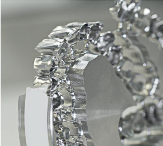
Abb. 11: Gefräste Versorgung aus einer CoCr-Legierung im Rohling.
