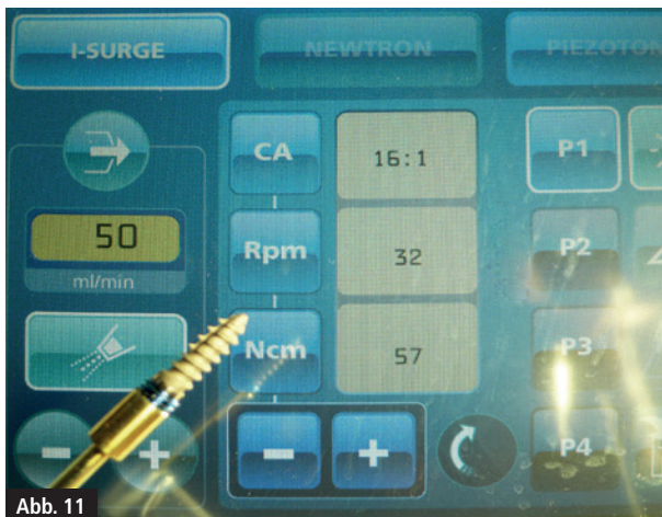
Abb. 11: Eindrehmomentermittlung standardisierter zweiteiliger Q2-Implantate mit dem Implant Center II. – Abb. 12: DVT vor und nach Insertion eines normierten 2-teiligen Q2-Implantates.
