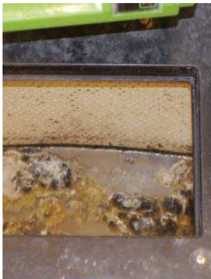
Biofilme in Trinkwasserinstallation und in dentaler Behandlungseinheit
