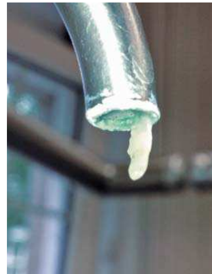
Biofilme in Trinkwasserinstallation und in dentaler Behandlungseinheit
