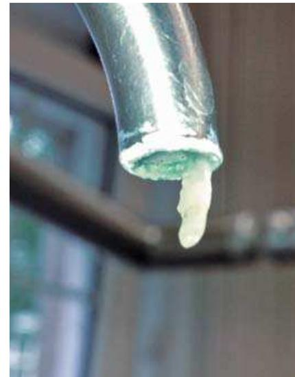
Biofilme in Trinkwasserinstallation und in dentaler Behandlungseinheit
