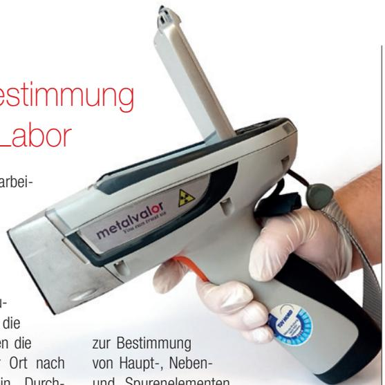
zur Bestimmung von Haupt-, Neben- und Spurenelementen. Dabei wird die Probe mittels Röntgenstrahlung untersucht. Die einzelnen Elemente erzeugen charakteristische Wellenlängen. Durch deren Messung lässt sich präzise feststellen, welche Elemente in welcher Konzentration in der Probe vorhanden sind. Die Ergebnisse werden automatisch gespeichert. Deren Wert kann anschließend, direkt vor Ort, basierend auf diesen präzisen Messwerten, gezahlt werden.
