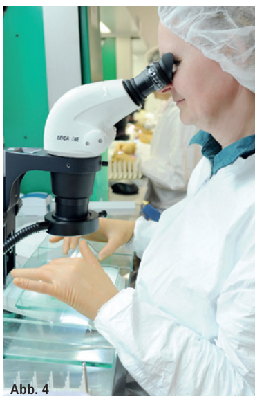
Abb. 4 und 5: Qualitätskontrolle jeder einzelnen Feile.
