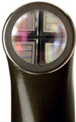
Die vier LEDs im niedrigen Kopf der VALO erzeugen drei verschiedene Wellenlängen. Eine Sammellinse bündelt das Licht zu einem homogenen Lichtstrahl, der kaum auffächert.
