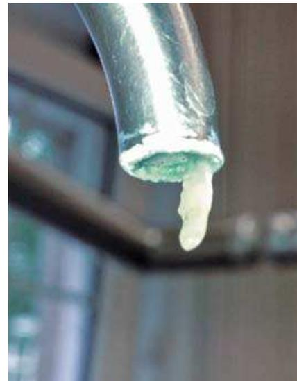
Biofilme in Trinkwasserinstallation und in dentaler Behandlungseinheit
