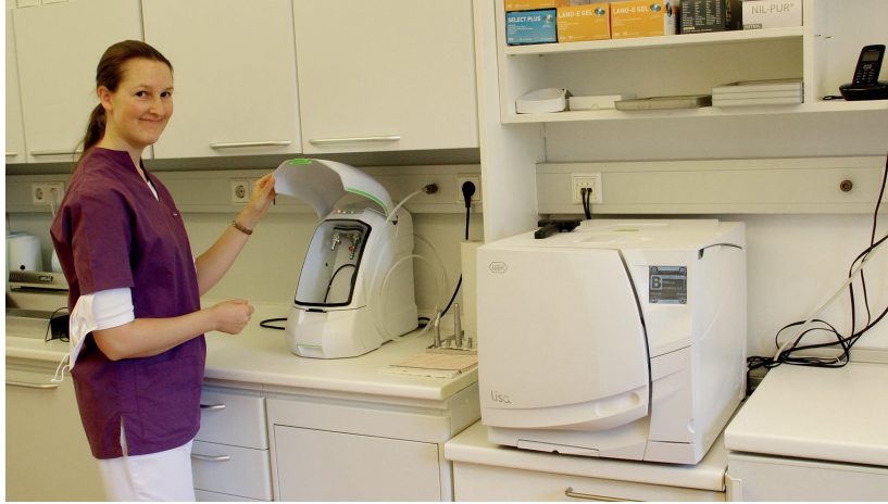
Abb. 3: Für Übertragungsinstrumente nutzt das Team der Praxis Dr. Ebenberger ausschließlich die Assistina 3x3 von W&H. Anschließend kommen die Instrumente in den Lisa-Sterilisator. Diese Kombination ermöglicht erstmals eine Aufbereitung zwischen zwei Patienten.
