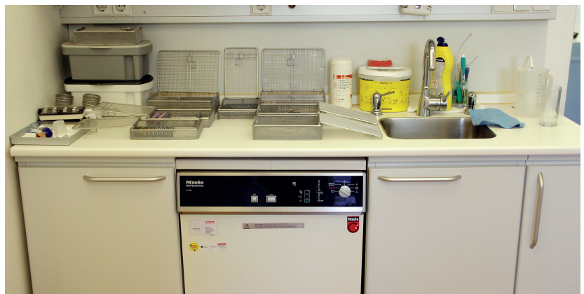
Abb. 2: Blick in den Sterilisationsraum – mit dem Miele-Thermodesinfektor wird sämtliches Instrumentarium, außer die Übertragungsinstrumente, gereinigt und desinfiziert.
