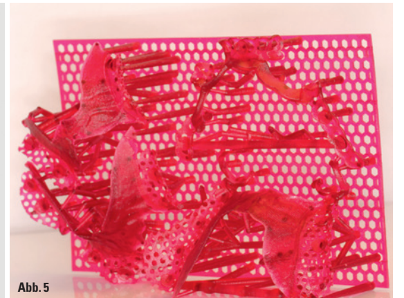
Abb. 1: Grafische Übersicht: Der 3-D-Druck trägt zur Effektivitätssteigerung in der Modellgusstechnik bei. – Abb. 4: Die STL-Daten (Konstruktion) werden in die Druckersoftware gespeist. Hier drucken wir sechs Gerüste in einem Arbeitsgang. Druckdauer circa zwei bis drei Stunden. – Abb. 5: Bauplattform nach Entnahme der gedruckten Objekte.
