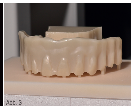
Abb. 1: In Wachs gefräste Konstruktion zur Kontrolle der Passung. Abb. 2: Das Gerüst wurde in Zirkoniumoxid (Zenostar) umgesetzt. Abb. 3: Sinterung des Gerüsts. Kleine Sinterdrops am Gerüst stützen die Restauration beim Sintern ab.
