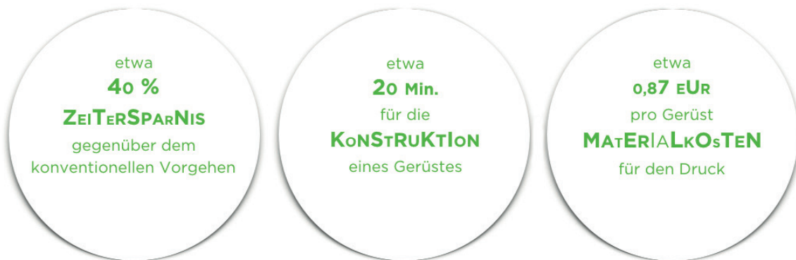
Grafische Übersicht: Der 3-D-Druck trägt zur Effektivitätssteigerung in der Modellgusstechnik bei.
