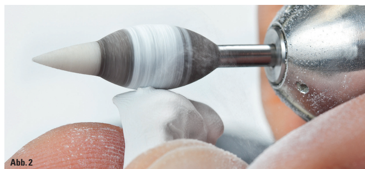
Abb. 2: Vor dem Sintern: Verschleifen der Haltestege mit dem Weißlingspolierer. – Abb. 3: Nach dem Sintern: Aufsprühen des transparenten Lithiumsilikats CeraFusion.
