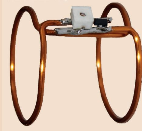
einen Zentimeter hohe Spule aus zwei parallel angeordneten Metallringen. Aufgrund ihrer elektrophysikalischen Eigenschaften verstärkt die Doppelspule die MRT-Signale des umschlossenen Gewebes. So wird eine Auflösungsgenauigkeit von etwa einem Drittel Millimeter erreicht, die der des Röntgens nahekommt. Die Spule funktioniert ohne
