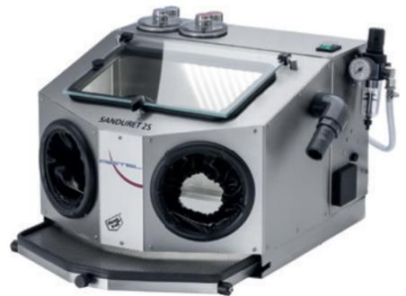
Die Mikrofeinstrahlgeräte der SANDURET Serie bieten ein optimales Abstrahlergebnis mit allen handelsüblichen Strahlmitteln von 25 bis 250 µm. Reinigen, Mattieren, Glänzen und Oxydbeseitigung gehören zu ihren Einsatzmöglichkeiten. Das spezielle Strahlprinzip und die beheizten Behälter sorgen für einen konstanten Materialfluss und verhindern ein Verklumpen und damit blockierende Düsen.
