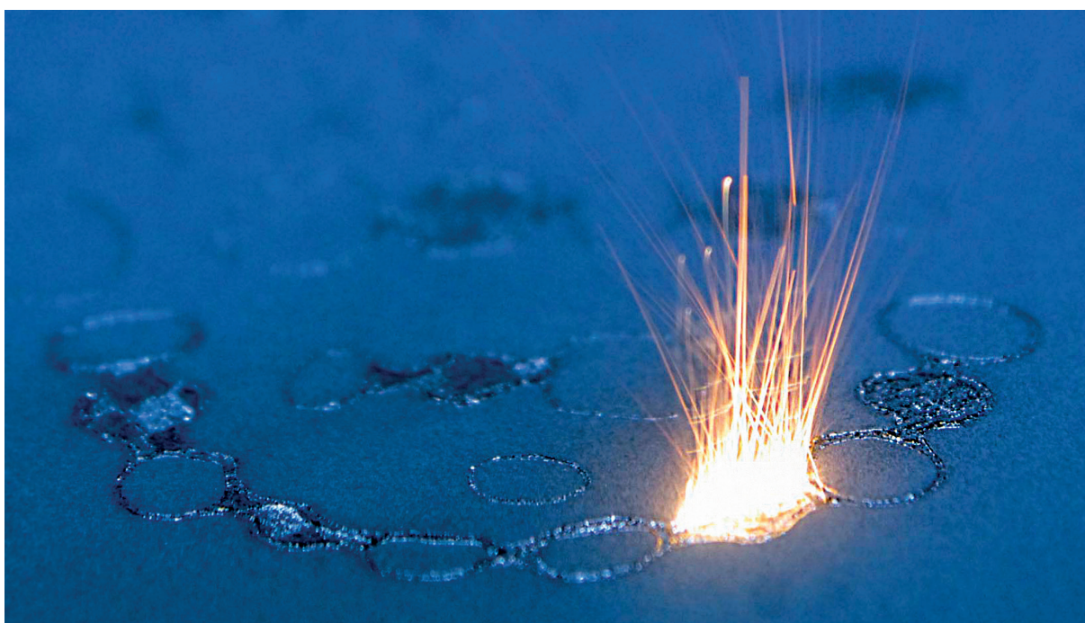
Abb. 1: Der additive Fertigungsprozess am Beispiel von Metall-Zahnkronen. (Quelle: EOS)
