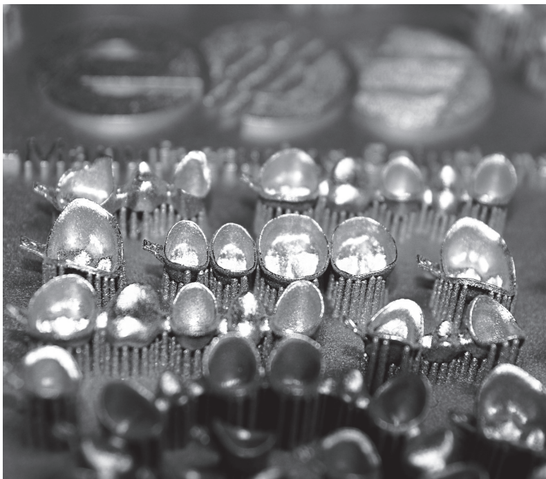
Abb. 2: Die additive Fertigung zeichnet sich als Schichtbauverfahren insbesondere dadurch aus, dass damit extrem kostengünstig und in hoher Zahl patientenindividuelle Zahnrestaurationen produziert werden können. (Quelle: EOS)
