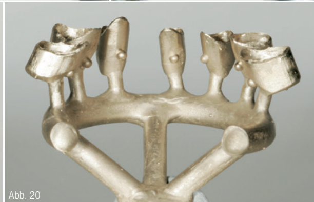
Abb. 16: Vorfäsen in Wachs. Abb. 17: Ränder freigelegt. Abb. 18: Mit Gusskanälen und Retentionsperlen. Abb. 19: Angestiftet im offenen Ring. Abb. 20: Ein perfekter Biolightguss.
