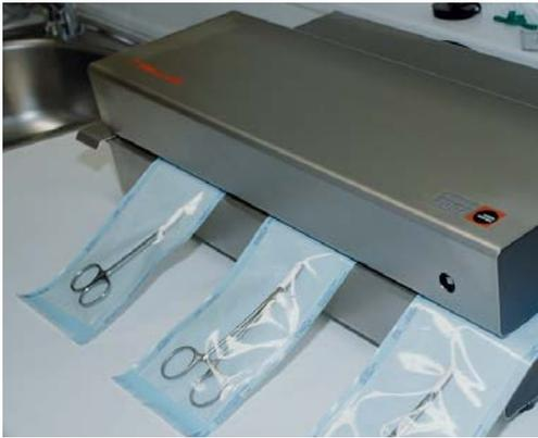
Abb. 2: Anwenderunabhängiger Siegelprozess mit überwachten Prozessparametern.
