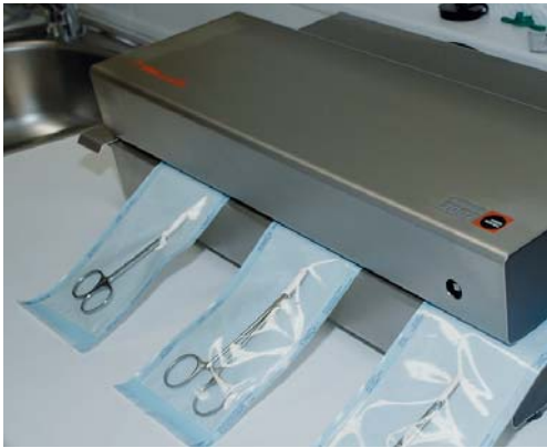
Abb. 2: Anwenderunabhängiger Siegelprozess mit überwachten Prozessparametern.
