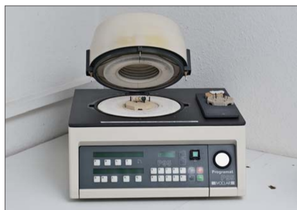
Abb. 5: Der Brennträger wird mit dem Gerüst mittig im Ofen platziert.
