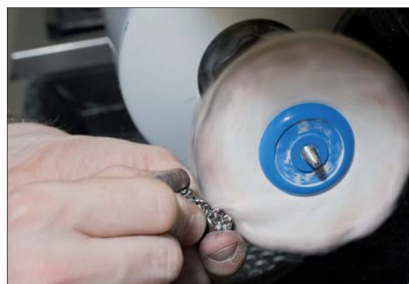
Abb. 29: ... oder einer Nesselschwabbel und Hochglanzpolierpaste am Polierautomaten.
