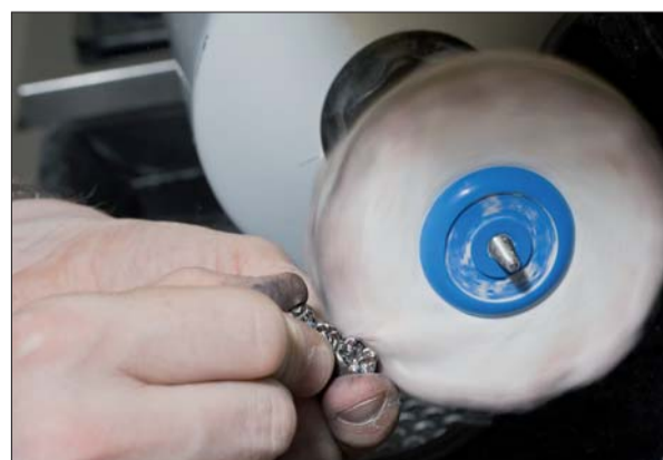
Abb. 29: ... oder einer Nesselschwabbel und Hochglanzpolierpaste am Polierautomaten.
