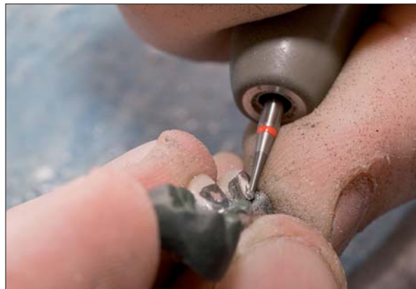
Abb. 18: Aus der Kaufläche wird die Oxidschicht mit einem fein verzahnten Hartmetall-Rosenbohrer entfernt.
