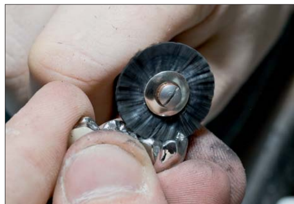
Abb. 26: ... und einer Handpolierbürste mit Polierpaste in Richtung des Kronenrandes vorgepoliert!
