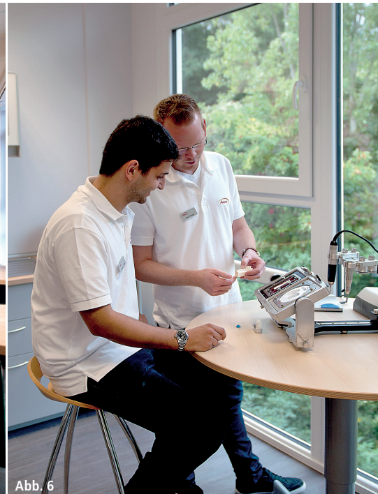
Abb. 5: Kursräume der Firma Argon Dental für ca. 30 Teilnehmer. – Abb. 6: Argon-Mitarbeiter am Präzisions-Pantograph OsteoGRAPH® zur Herstellung dreidimensionaler allogener Knochentransplantate. – Abb. 7: Rayscan Alpha Plus.
