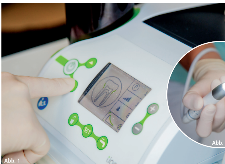
Abb. 1: Vier voreingestellte und ein frei wählbares Programm ermöglichen ein effizientes Arbeiten. – Abb. 2: Die gute Ausleuchtung mittels 5-fach LED-Ring erlaubt eine gezielte und effiziente Konkremententfernung. (Fotos: Heimo Spindler)
