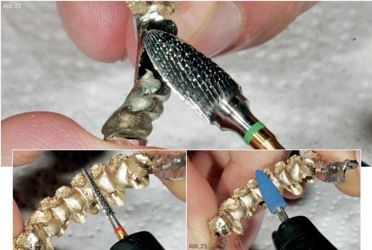
Abb. 23: Ausarbeiten der MG-Retentionen mit kreuzverzahntem Fräser. Abb. 24: Bearbeiten der Lingualflächen. Abb. 25: Gummieren zum Mattglanz. Abb. 26: Ränder ausgearbeitet. Abb. 27: Das fertige Gerüst nach Politur. Abb. 28: Ausmodelliert mit Zähnen.
