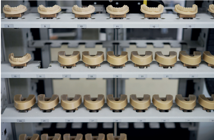
In der vollautomatischen Produktion fertigt jede Maschine in zwei Schichten bis zu 80 Modelle täglich.
