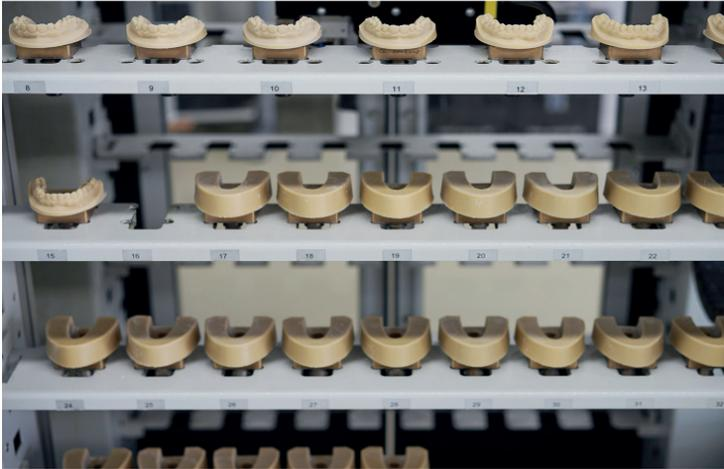
In der vollautomatischen Produktion fertigt jede Maschine in zwei Schichten bis zu 80 Modelle täglich.
