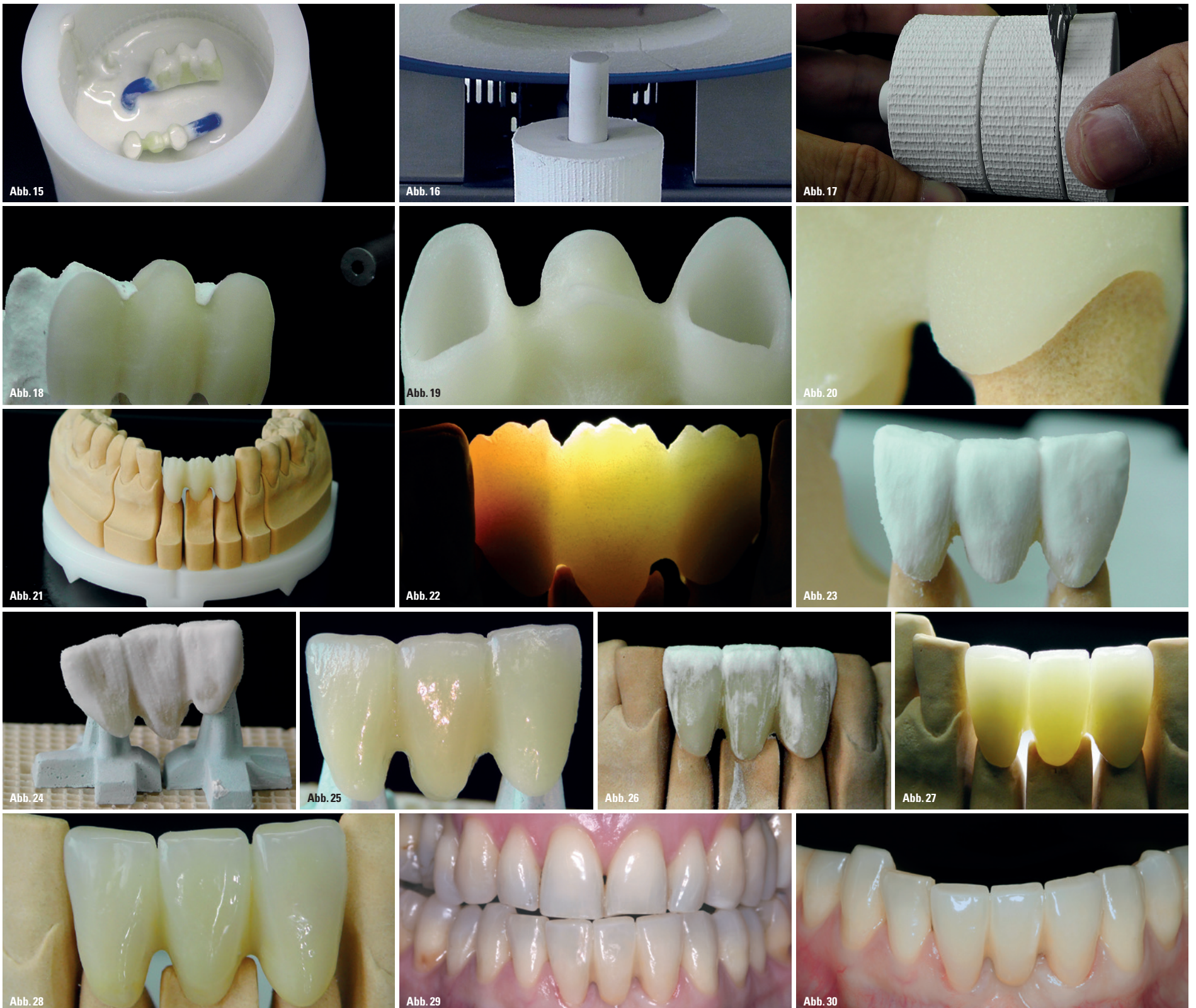
Abb. 15: Einbettung mit Celtra Press Investment. – Abb. 16: Einsetzen der Muffel in den Pressofen. – Abb. 17: Ausbetten der Objekte. – Abb. 18: Nach dem Ausbetten ist keine Reaktionsschicht auf den Objekten vorhanden. – Abb. 19: Gerüst nach dem Abstrahlen: keine Reaktionsschicht und gestochene scharfe Objektstrukturen. – Abb. 20: Ausgezeichnete Initialpassung ohne Ausarbeitungen. – Abb. 21: Die Brücke auf dem Meistermodell. – Abb. 22: Opaleszenz aus der Celtra Press Matrix. – Abb. 23: Erster Dentinbrand. – Abb. 24: Objekt auf den Zirkonbrennträgern. – Abb. 25: Verblendung nach dem ersten Dentinbrand. – Abb. 26: Komplettierung der anatomischen Form zum zweiten Dentinbrand. – Abb. 27: Nach dem zweiten Brand im Durchlicht: ausgezeichnete Lichtdynamik. – Abb. 28: Großaufnahmen der Brücke von vestibulär. – Abb. 29: Fertiggestellte Brücke mit Gegenbeziehung. – Abb. 30: Hohe Ästhetik der finalen Restauration.
