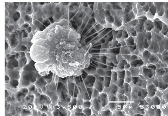
Abb. 4: Ein Osteoblast verankert sich auf der Friadent-plus-Oberfläche eines Xive-Implantats.
