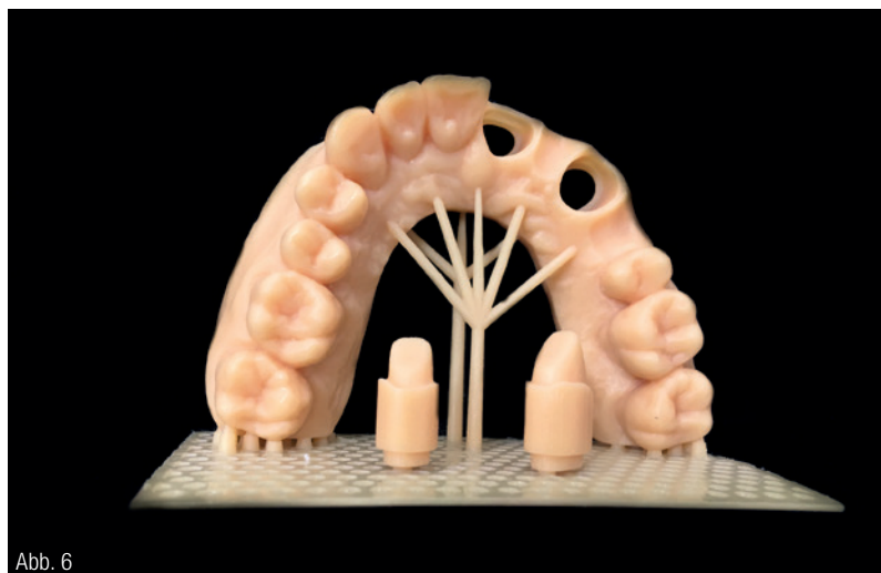
Abb. 6: Im Drucker hergestelltes Alveolen-Modell nach dem Druckprozess.
