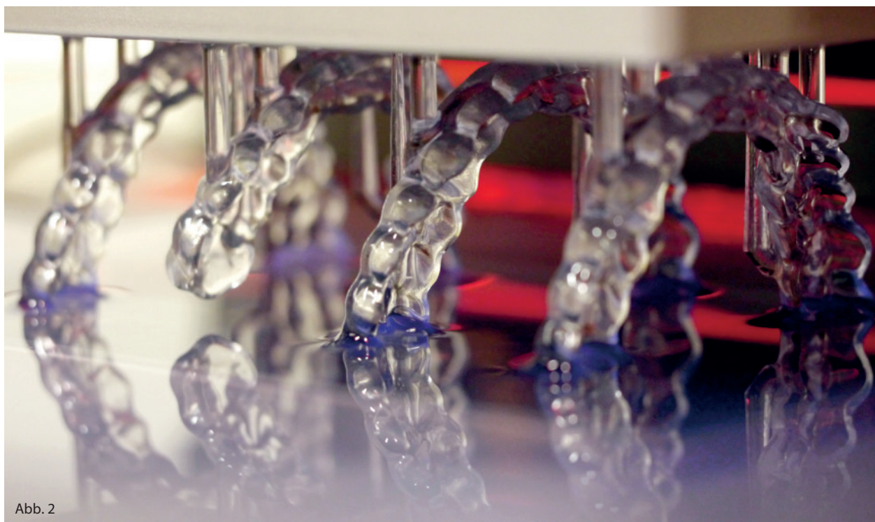
Abb. 2: Druckvorgang der Schienen.
