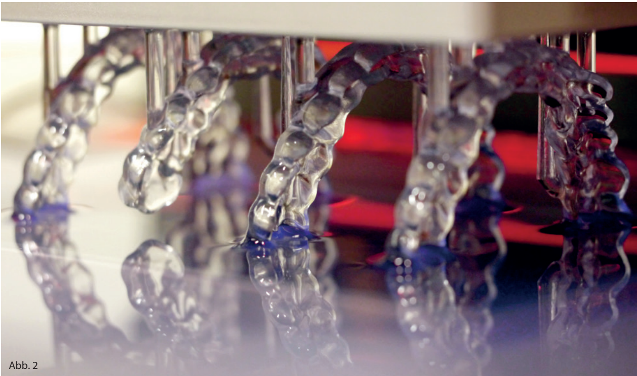
Abb. 2: Druckvorgang der Schienen.
